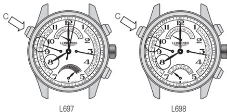
**Вариант б:** Вы едите в Японии и хотите, чтобы часы показывали действующее там время и дату. Вращая вперед заводную головку (в положении **2**), установите часовую стрелку на отметку «4» (в Японии сейчас 16:00) и снова прижмите заводную головку к корпусу. Индикатор времени второго часового пояса по-прежнему показывает 8:00 утра (время в Женеве, то есть дома).
