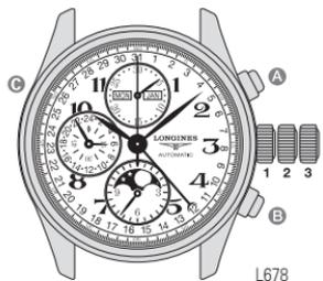
Индикация часов, минут, секунд, даты, дня недели, месяца и фаз Луны. Этот хронограф позволяет измерять время отдельных событий продолжительностью до 12 часов с точностью до 1/5 секунды.
