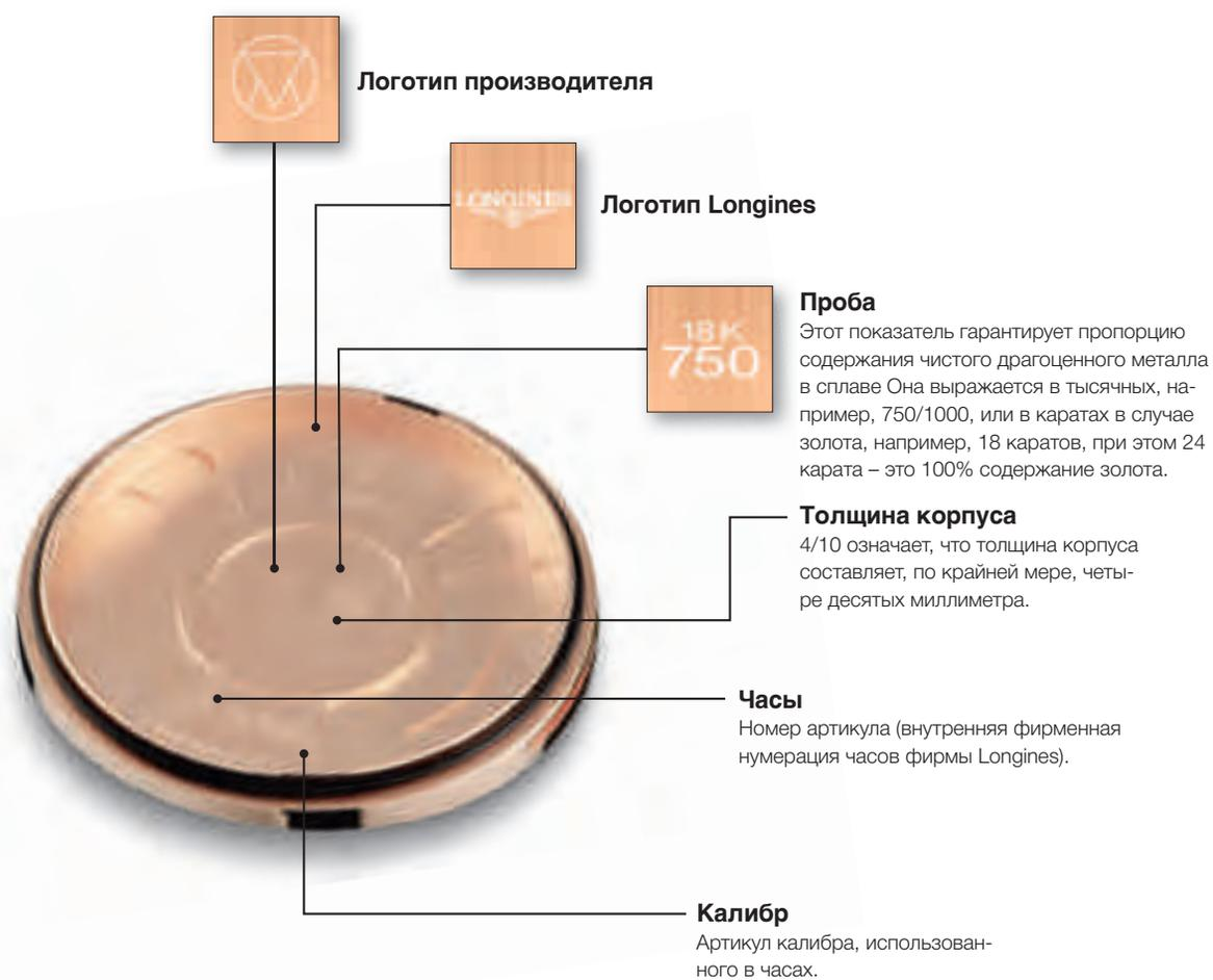
**На внутренней поверхности задней крышки корпуса**
